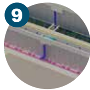
9 Sistema de remoção de lodo Encaminha o lodo descartado para a desidratacao
