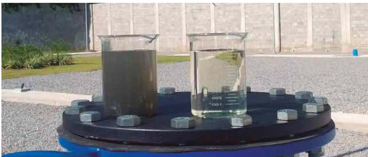
Foto comparando o esgoto sanitário de entrada (esquerda) e o efluente de saída do reator BRC (direita).
