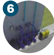
6 Sistema de aeracao Fornecimento de oxigenio para a zona aerobica
